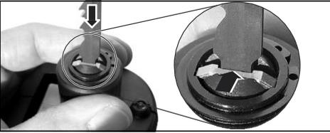
**ملاحظة:** في حال وقوع أن نصلة المنشار قد انكسرت ولا يمكن إزالتها باليد من جهاز التثبيت السريع لنصلة المنشار، قم بتدوير جلبة التثبيت (1) باتجاه السهم وثبتها. استخدم طرف نصلة المنشار في القسم المكسور لسحبها. نصلة منشار المعادة ذات الأسنان الدقيقة هو الأفضل لهذه المهمة.
